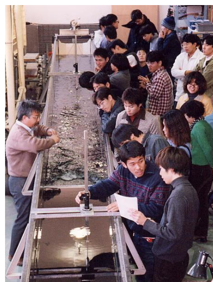
図 6-3 開水路での水面形の測定
