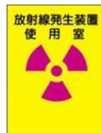
図 4-2 放射線発生装置使用室の表示例
